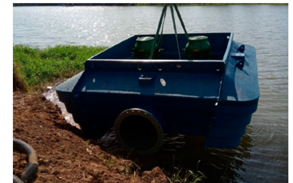
Flutuador das bombas da estação de reversão
